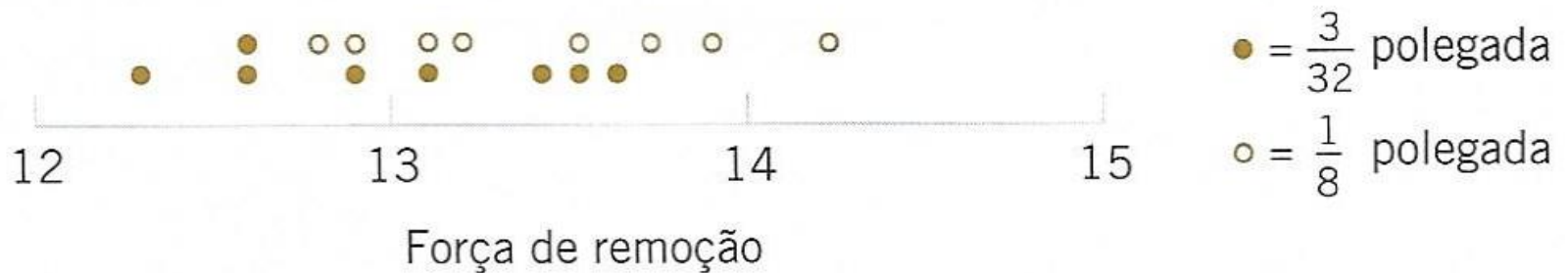
Fig. 0.3 Diagrama de pontos dos dados de força de remoção para duas espessuras de parede
