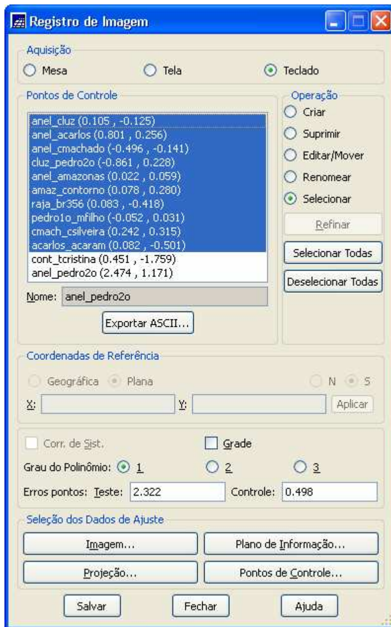
Figura 6.14 – Janela Registro de Imagem: seleção ótima de pontos de controle testada. Foi selecionado o maior número possível de pontos tal que o valor do erro de pontos de controle manteve-se menor que 0,5
