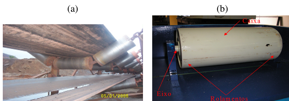
Figura 1. Em (a) Roletes em correias transportadoras, em (b) detalhe dos roletes.
